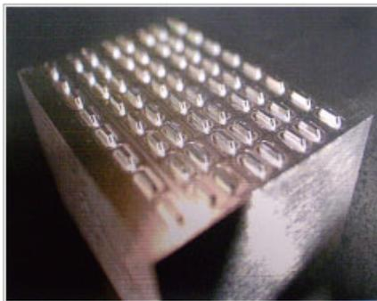
仕上げ加工した金型(LEDコアピン64ヶ所) 被削材: ELMAX(HRC60)
