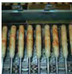
→きりたんぼの自動製造装置による焼上状況
