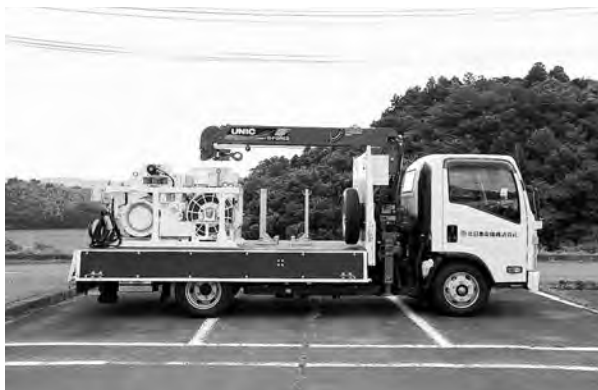
ケーブル張替工事フルアシスト装置
