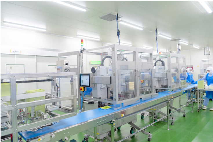
惣菜盛付ロボット「Delibot」 出典:コネクティッドロボティクス(株)提供
