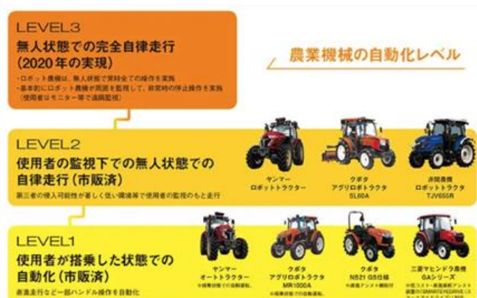
第2-5-2図表 ロボットトラクターの自動走行のレベル
