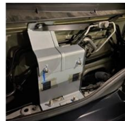
車外モニタリング用センサー (フロントフード内に設置)
