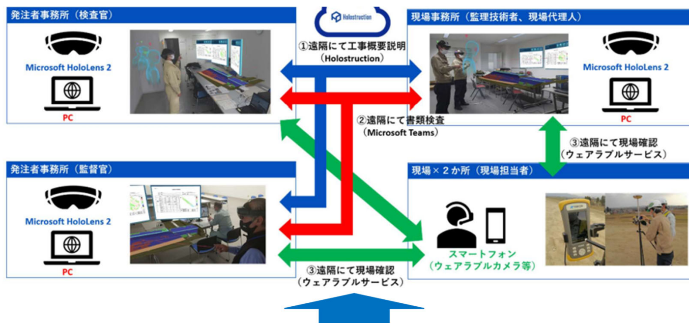
Holostructionによる遠隔検査概要図とその狙い
