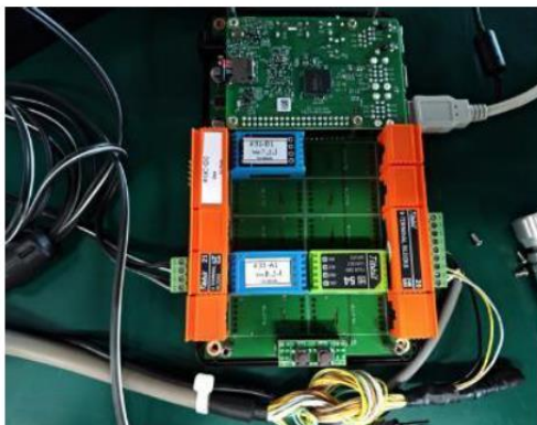
図表 5-8-4 「Tibbo-Pi」によるオリジナル IoT デバイス・システム作成方法
