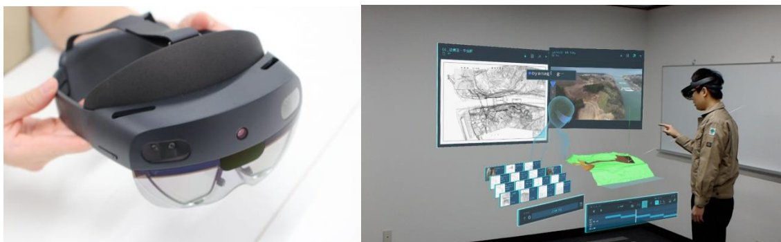
図表5-4-3 ホロレンズ（左）と Holostruction を使った施工監理（右）
