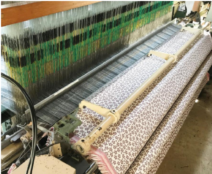
図表5-2-3 PHOTOTEXでジャガード織機を制御し模様を織り込む
