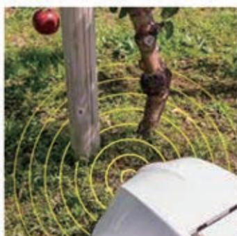
超音波センサーで障害物を検知
