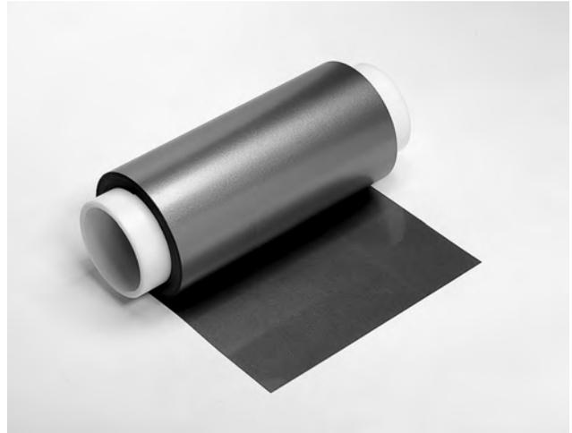
同社が「バスタレイド」と呼ぶ電子機器の雑音抑制シートである。電子回路が発する雑音の発生源付近にシールのように張り付けることで、高周波の雑音が周辺の回路に与える影響を軽減する。ノートパソコンやモバイル端末の小型化、高密度実装を支える部品だ。
