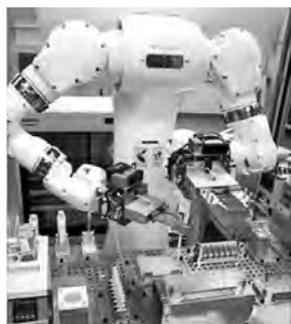
双腕ロボットシステム「まほろ」創薬分子ウロファイリングRC・安川電機
