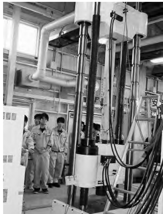
(継ぎ手の引っ張り試験中の様子)
