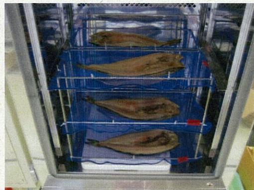
図2 低温除湿乾燥装置内に設置した乾燥棚
