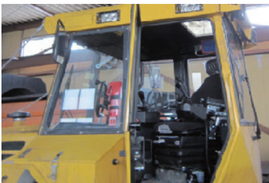
写真5 ヨーロッパ製林業機械のキャビン
