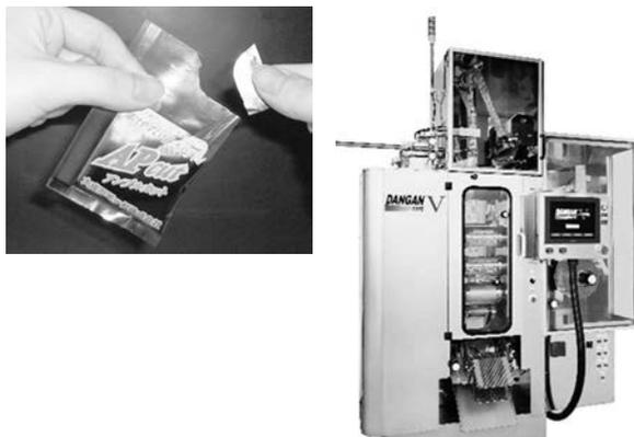
写真 4-5 アンプルカットとその製造装置「DANGAN TYPE-V」(株式会社悠心提供)
