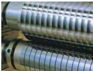
↑ナイフユニット ↑超硬合金製スリッターナイフ(下刃)
