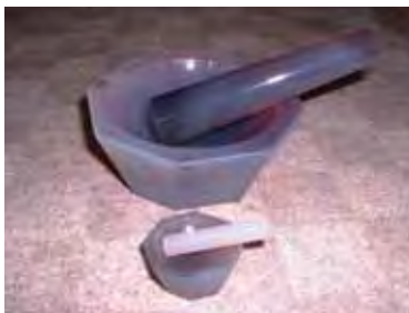
↑ 3軸振動回転式自動粉碎機 メノウ乳鉢
