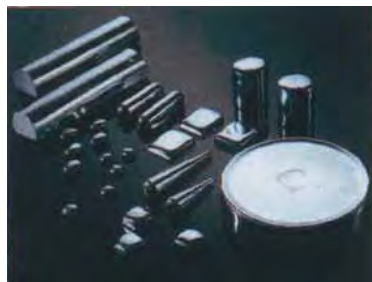
↑高純度ガリウムを用いたGaAs基板
