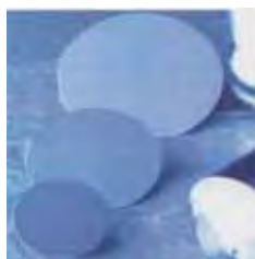
↑高純度ガリウムを用いたGaAs基板
